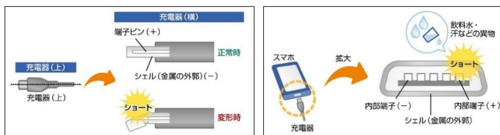
図 13 充電コネクタの破損及び異物の付着 (イラスト提供:MCPC)
