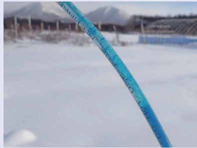
土壌凍結深計の色水チューブ凍っている境目が見えます
