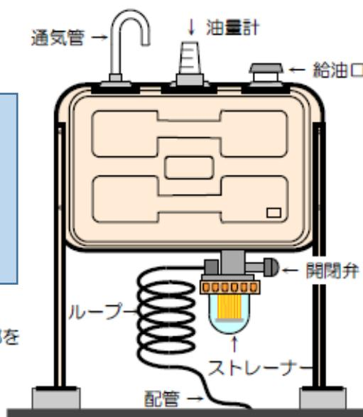
配管などは腐食などの劣化によって、非常に小さな穴が開くことがあります。埋設配管などのように目で確認できない箇所に非常に小さな穴が開いている場合は、臭いもなく漏えい量も少ないことから気づくのが遅れることがあります。
